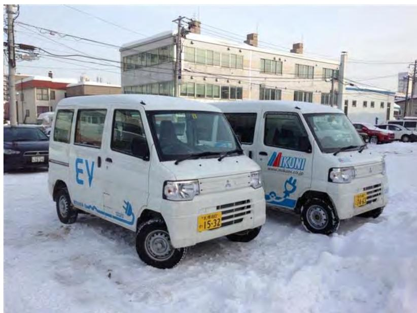
図5.17 調査車両（左：PTCヒーター使用車、右：燃焼式温水ヒーター使用車）
