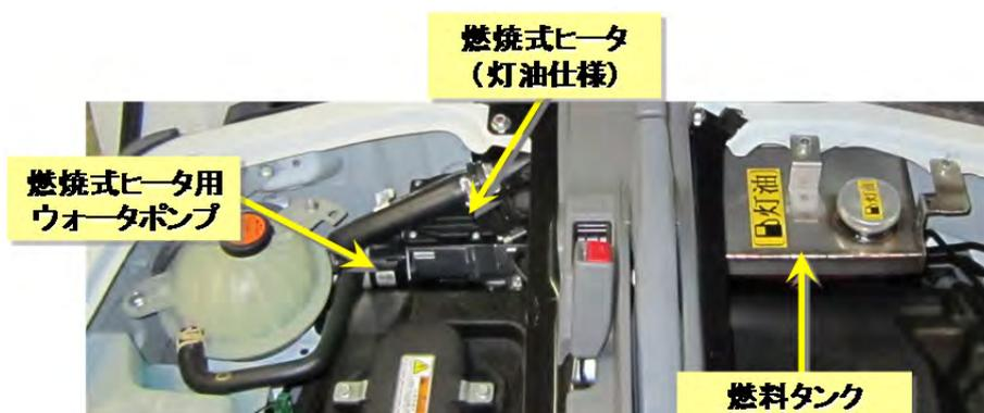
図5.18 燃焼式温水ヒーター取付状況
